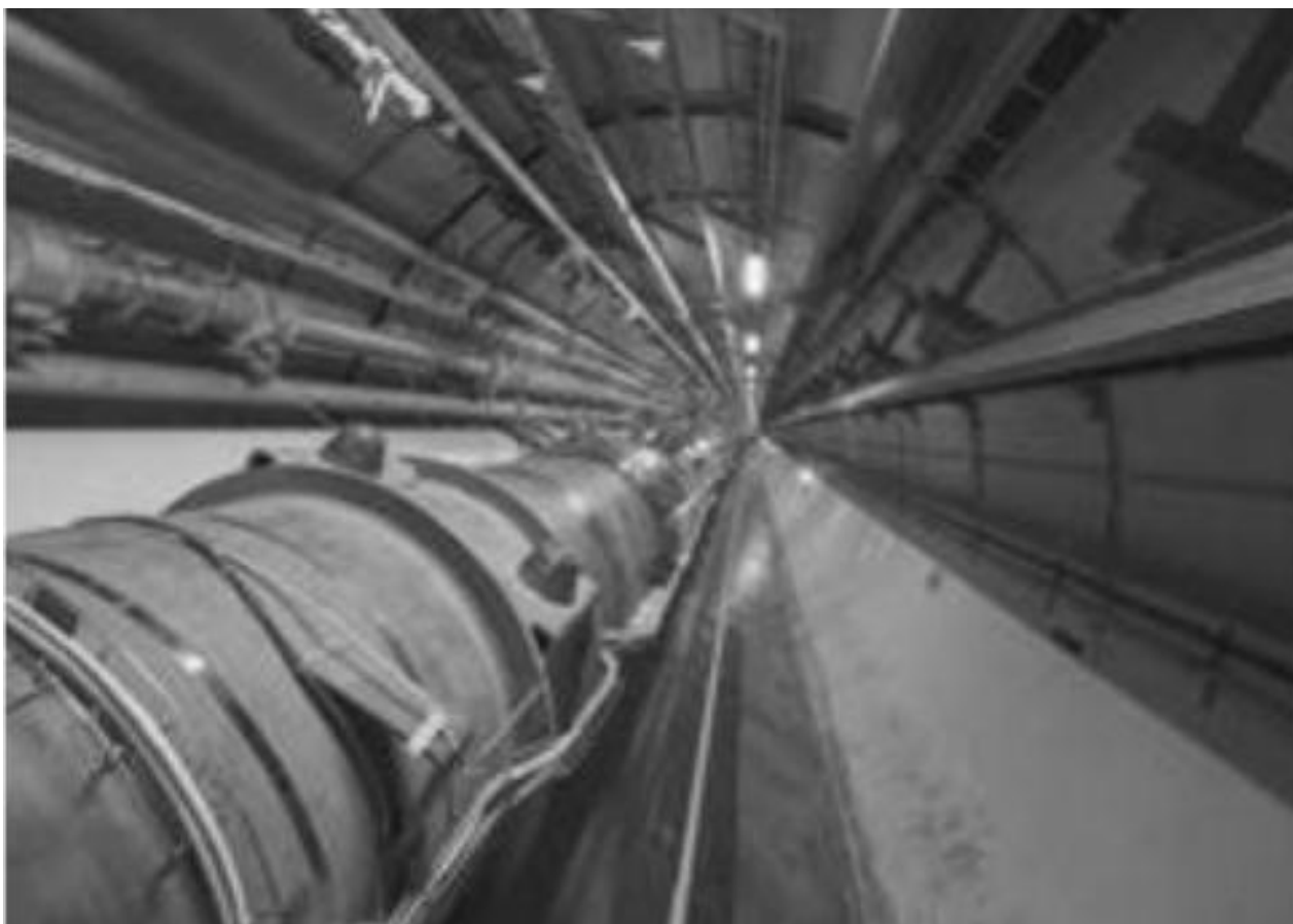
Fig. 13 ▶ Vue de l'intérieur du tunnel circulaire de 27 km du Grand collisionneur de hadrons (LHC) du CERN, Genève. Deux faisceaux de protons circulent en sens inverse à travers les champs de centaines d'aimants spécialement conçus, à des énergies allant jusqu'à 6,5 TeV.
