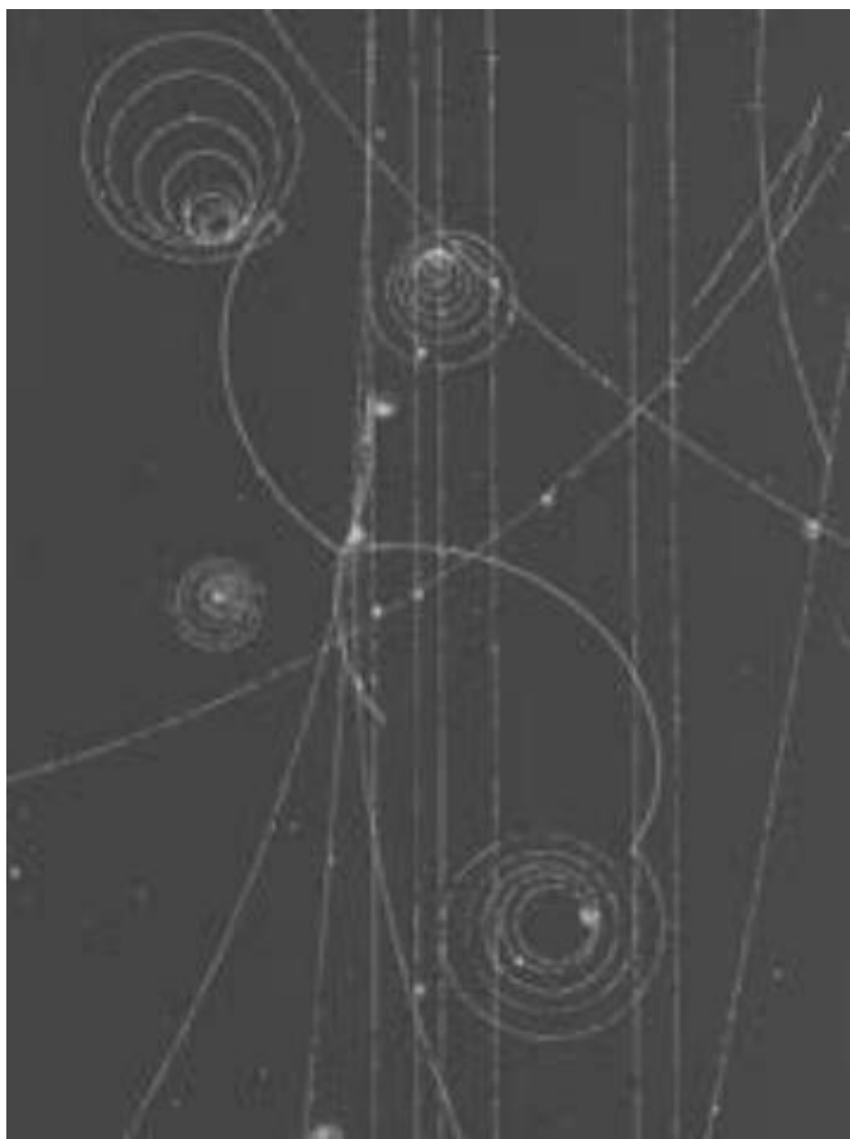
Fig. 15 ● Particules subatomiques observées dans la chambre à bulles du CERN. Les rayons cosmiques ont permis aux physiciens d'entrevoir pour la première fois de nouvelles particules subatomiques, qui ont ensuite été étudiées en détail lors d'expériences menées dans des accélérateurs de particules. Positrons, muons, pions et kaons figurent sur cette photographie prise dans la chambre à bulles de 2 m du laboratoire du CERN.
