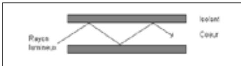
Fig. 7. Fibre multimode à saut d'indice
